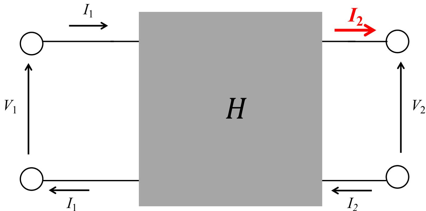
$$\begin{bmatrix} V_1 \\ I_2 \end{bmatrix} = \begin{bmatrix} H_{11} & H_{12} \\ H_{21} & H_{22} \end{bmatrix} \begin{bmatrix} V_2 \\ I_1 \end{bmatrix}$$
