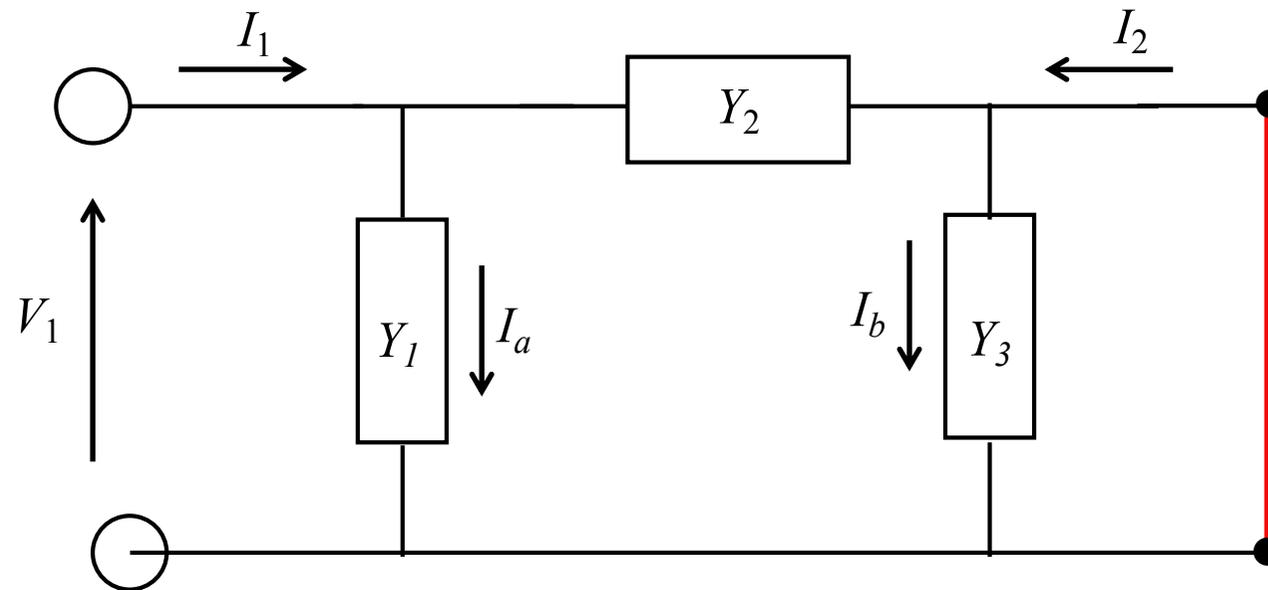
まず、出力端短絡( $V_2 = 0$ )で、 $V_1$  を印加した場合、
