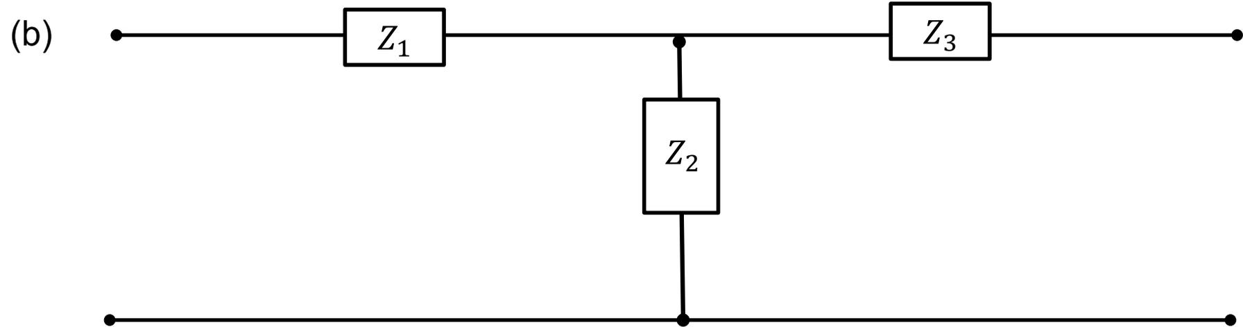
図に示した対称格子形回路をこれと等価な図(b)のT型回路に等価変換したい、インピーダンス $Z_1$ 、 $Z_2$ 、 $Z_3$ を決定せよ。ただし、 $R_1 = 5[\Omega]$ 、 $R_2 = 15[\Omega]$ 、 $L = 10[mH]$ 、角周波数 $\omega = 1000[rad/s]$
