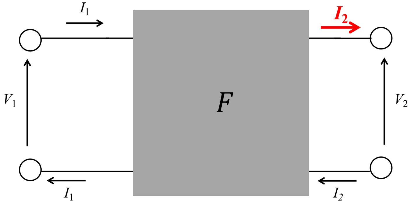
$$\begin{bmatrix} V_1 \\ I_1 \end{bmatrix} = \begin{bmatrix} A & B \\ C & D \end{bmatrix} \begin{bmatrix} V_2 \\ I_2 \end{bmatrix}$$
