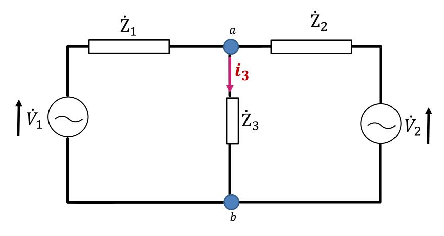
問題: インピーダンスŻ<sub>3</sub>に流れる電流**i<sub>3</sub>をテブナン** の定理を適用して求めよ、、、
