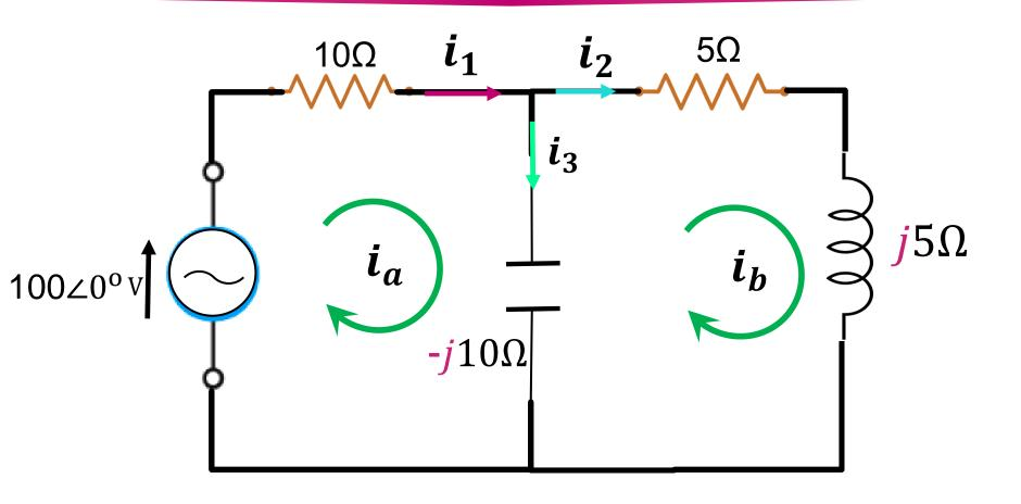
問題: 電流 $i_1$ , i,  $i_3$  のフェーザ表示をループ**電流法**(KVL法)を用いて求めよ!
