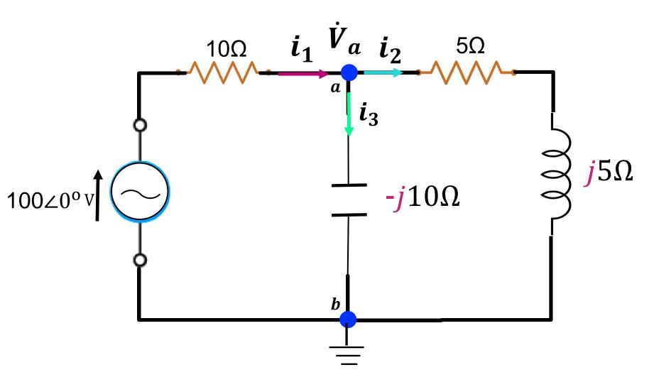
問題: 電流 $i_1$ , i,  $i_3$  のフェーザ表示を節点解析法(KCL法)を用いて求めよ!
