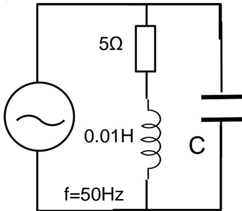
図示したRLC回路に正弦波交流を加えた時に力率 $\cos\varphi=1$ になるようなキャパシタンスCの値を求めなさい！
