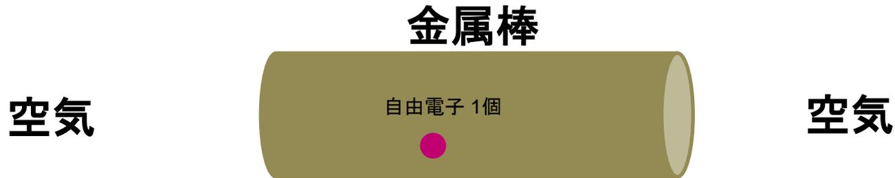
電子は金属内では自由電子である。空気が絶縁体なので、電子が金属棒から出ることにはできないようになっている
