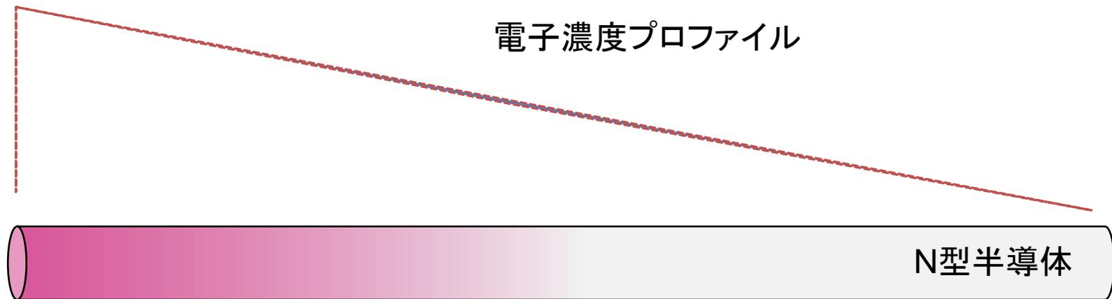
条件： ①熱平衡→外部電場、外部光励起はない、全電流  $J = 0$
